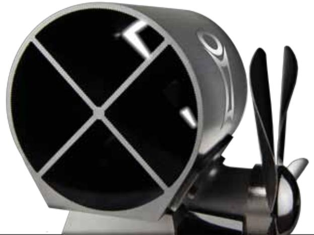
SmartFan は、固体燃料式ストーブの熱循環を改善する、無音動作のクリーンで効率的な電源自蔵型機器です。本器では、熱電発生モジュール(TEM),を電源として利用し、ストーブの熱面を用いて電流を発生させることによって2台のファンを駆動しています。熱が直接天井に向けて放射されずに、生活空間に直接放散されるので、室内の快適性が向上し、燃料効率が改善されます。本器の動作原理はきわめて簡単です。
